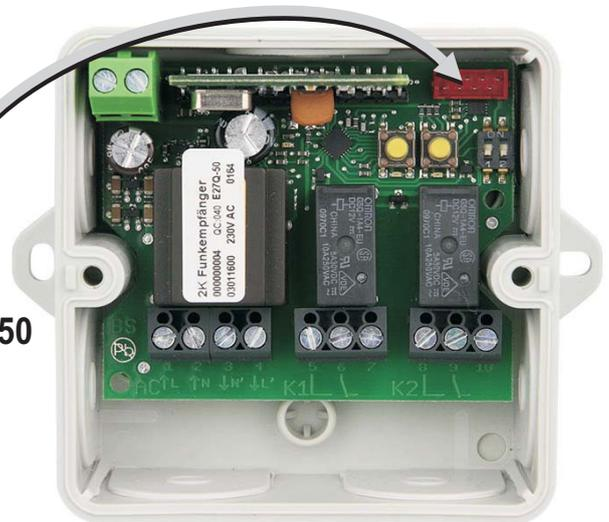
Für die Funktionserweiterung wird zusätzlich die QuickLog25-50 Steckkarte benötigt
