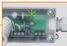
Visuelle Darstellung der ordnungsgemäßen Funktion der Schalteiste dank eines LED-Signals, das durch die transparente Anschlussbox zu sehen ist.
