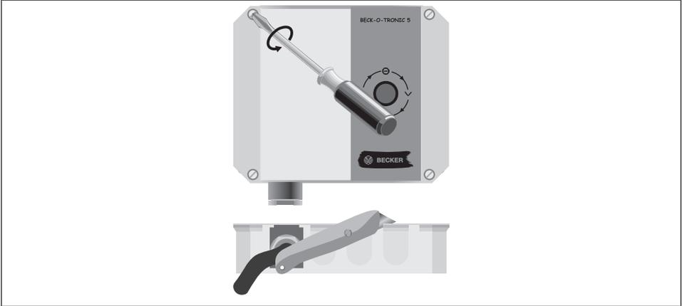
**i** **Schneiden Sie die Kanten ein, damit sich die Ausbrüche leichter entfernen lassen.**
