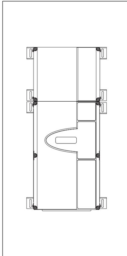
3-3.4 Steuerungsgehäuse und Erweiterungsgehäuse mit horizontal befestigten Montagefüßen
