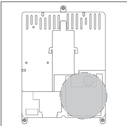
4-3.5 Lage der Systemleitungsanschlüsse X40/X42 auf der Steuerungsplatine
