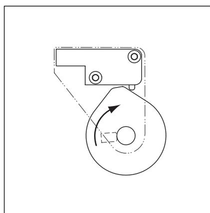
6-13.5 Schaltrichtung des Schaltnockens S2 - Sicherheits-Endschalter Tor-Zu -
