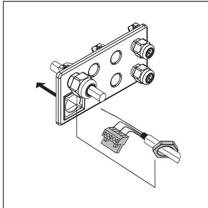
4-2.5 Stecker und Befestigungsmutter durch die Flanschplatte fädeln
