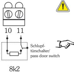
Der 8k2-Widerstand muss unbedingt im Schlupftürschalter oder am Ende der Nebenschließkante angeschlossen werden./It is important that the 8k2 resistor is connected in the pass door switch or to the end of the secondary safety edge.
