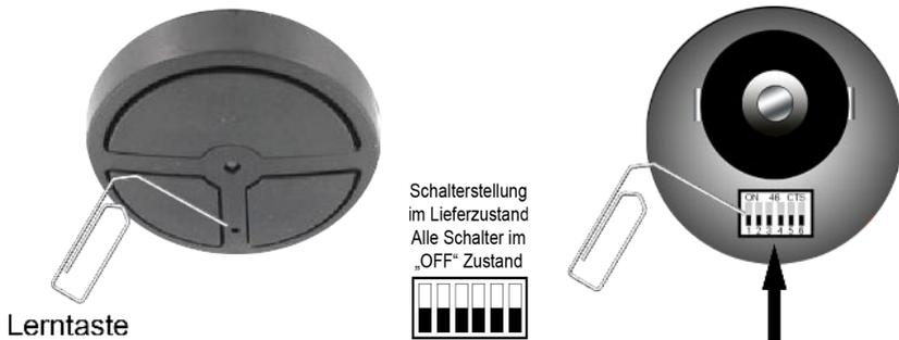
Drehen Sie den KFZ Multi-Cloner entsprechend (Bild 2) um. Mit einer aufgebogenen Büroklammer, können Sie die DIP Schalter einstellen.
