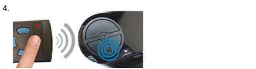
2. Betätigen Sie nun die gewünschte Taste des KFZ Cloners einmal kurz, welche Sie einlernen möchten. (Dieser Vorgang muss in der Zeit geschehen, in dem der Cloner leuchtet!) Die LED Lampe geht nun aus, der Cloner befindet sich jetzt im Lernmodus.
