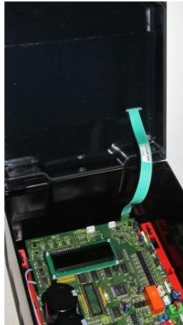
Abbildung 3: Montagestellung des Deckels, Anschluss der Folientastatur
