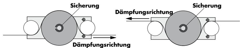
Die Maßzeichnung zeigt die werkseitig eingestellte Laufrichtung der Dämpfungsscheibe (siehe Abbildung unten). In welche Richtung der Seilzug gedämpft wird, hängt davon ab, wie Sie das Seil um die Scheiben führen (siehe Abbildungen oben). Gegebenenfalls können Sie die Dämpfungsrichtung aber auch ändern, indem Sie die Sicherung lösen, die Dämpfungsscheibe abnehmen und sie andersherum wieder auf die Achse setzen. Vergessen Sie nicht, die Scheibe wieder zu sichern.
