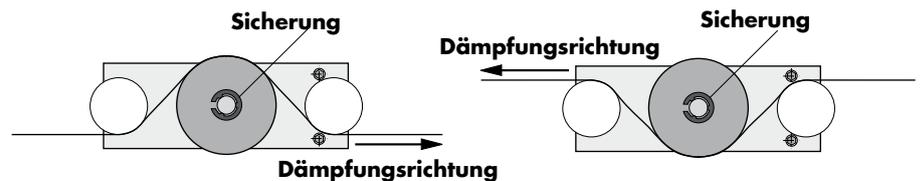
Die Maßzeichnung zeigt die werkseitig eingestellte Laufrichtung des Dämpfungsrad (siehe Abbildung unten). In welche Richtung die Kette gedämpft wird, hängt davon ab, wie Sie die Kette um die Kettenräder führen (siehe Abbildungen oben). Gegebenenfalls können Sie die Dämpfungsrichtung ändern, indem Sie die Sicherung lösen, das Dämpfungsrad abnehmen und es andersherum wieder auf die Achse setzen. Vergessen Sie nicht, das Rad wieder zu sichern.
