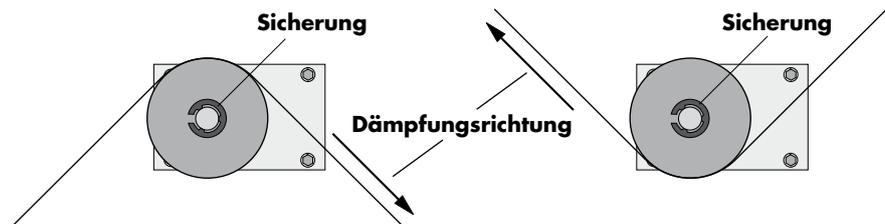
Die Maßzeichnung zeigt die werkseitig eingestellte Laufrichtung des Dämpfungsrad (siehe Abbildung unten). In welche Richtung das Seil gedämpft wird, hängt davon ab, wie Sie das Seil um das Rad führen (siehe Abbildungen oben). Gegebenenfalls können Sie die Dämpfungsrichtung ändern, indem Sie die Sicherung lösen, das Dämpfungsrad abnehmen und es andersherum wieder auf die Achse setzen. Vergessen Sie nicht, das Rad wieder zu sichern.
