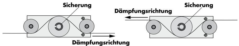
Die Maßzeichnung zeigt die werkseitig eingestellte Laufrichtung der Dämpfungsscheibe (siehe Abbildung unten). In welche Richtung der Seilzug gedämpft wird, hängt davon ab, wie Sie das Seil um die Scheiben führen (siehe Abbildungen oben). Gegebenenfalls können Sie die Dämpfungsrichtung aber auch ändern, indem Sie die Sicherung lösen, die Dämpfungsscheibe abnehmen und sie andersherum wieder auf die Achse setzen. Vergessen Sie nicht, die Scheibe wieder zu sichern.
