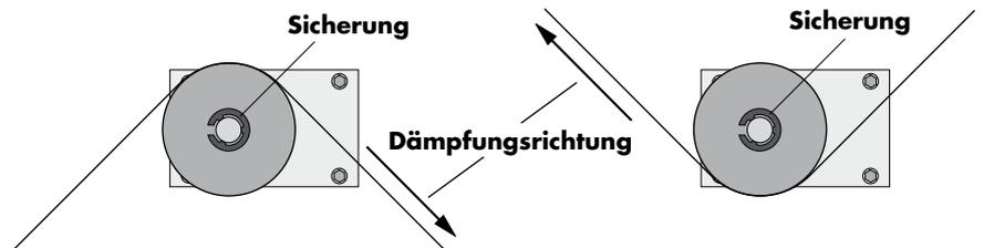
Die Maßzeichnung zeigt die werkseitig eingestellte Laufrichtung des Dämpfungsrad (siehe Abbildung unten). In welche Richtung die Kette gedämpft wird, hängt davon ab, wie Sie die Kette um das Rad führen (siehe Abbildungen oben). Gegebenenfalls können Sie die Dämpfungsrichtung ändern, indem Sie die Sicherung lösen, das Dämpfungsrad abnehmen und es andersherum wieder auf die Achse setzen. Vergessen Sie nicht, das Rad wieder zu sichern.
