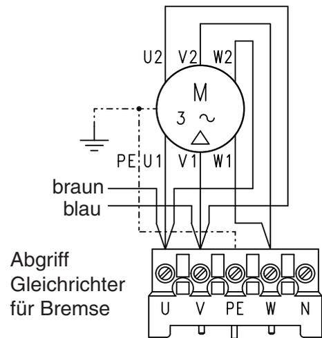
Wechselstrom 1x230 V AC, N, PE
