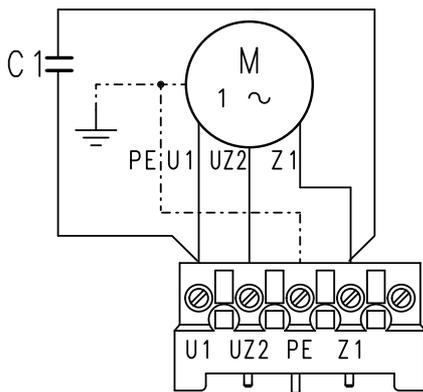
Wechselstrom 1x230 V AC, N, PE
