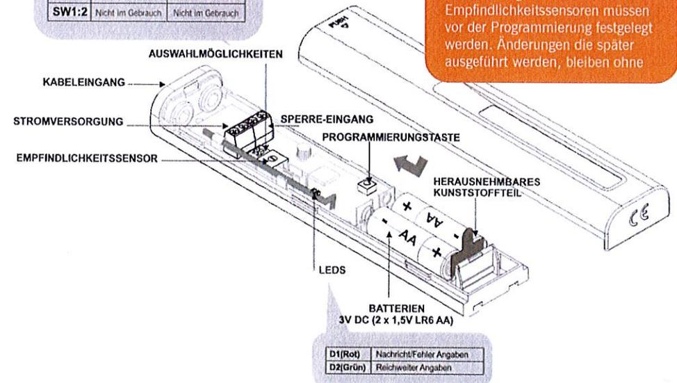
Einstellung der Auswahlmöglichkeiten und Empfindlichkeitssensoren müssen vor der Programmierung festgelegt werden. Änderungen die später ausgeführt werden, bleiben ohne
