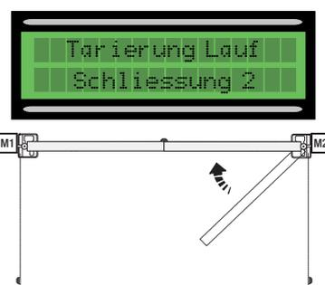
5) ...danach öffnet sich der Torflügel des zweiten Motors bis zum Toranschlag...
