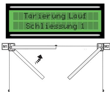
4) ... anschließend führt der Torflügel des zweiten Motors dieselbe Torbewegung durch...
