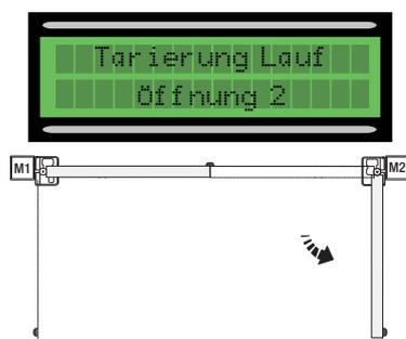
6) ... abschließend führt der Torflügel des ersten Motors dieselbe Torbewegung durch.
